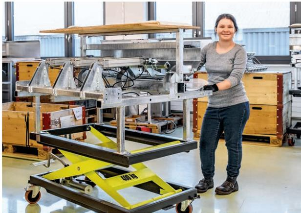
In Zusammenarbeit mit einem Auftraggeber wurden Maschinen auf höhenverstellbaren Wagen montiert, sodass sie individuell auf die bedienende Person angepasst werden kann. Auch Lagerpaletten wurden erhöht, um die Rüstarbeiten zu optimieren.
